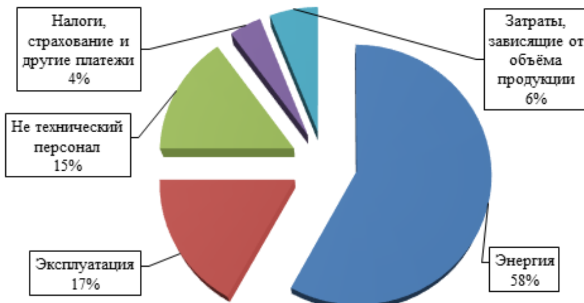
Рисунок 6 – Среднестатистическое распределение эксплуатационных затрат для нефтеперерабатывающих и нефтехимических производств [7]
