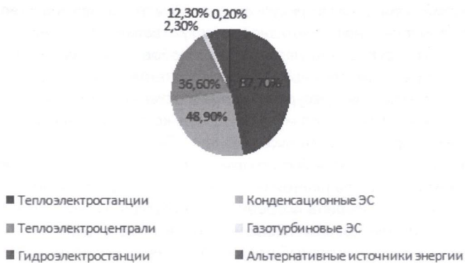
Выработка энергии по типу электростанций в РК
